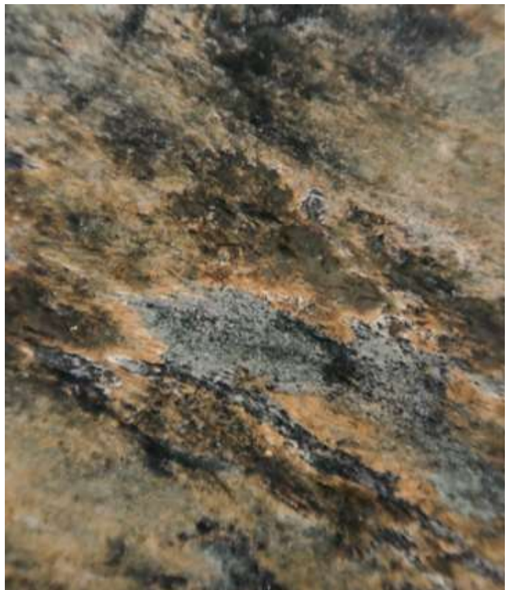
Serpentiniet vergroot. Rondom het zwart grijze pyroxeen is het omzettingproduct chloriet te zien.
